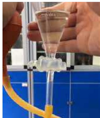
图1 模拟d处保留少量水时气体逸出的情况
